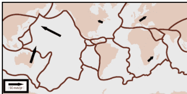
Figure 16. Exemple de détermination des vitesses de plaques tectoniques par VLBI
